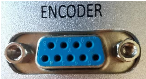
图 2.2.5 编码器接口引脚 (DB9)
