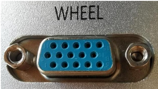
图 2.2.4 手轮接口引脚（DB15）
