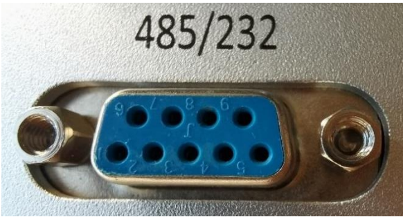
图 2.2.2 通信接口引脚（DB9）
